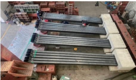
3. 콘크리트 주입 및 양생 (Preflex filled with tube Concrete) - 사전응력도입
